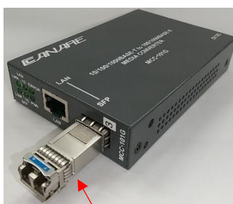
光 SFP を SFP スロットに挿入
